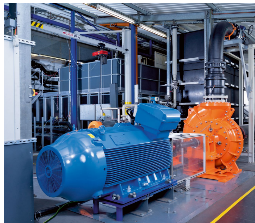
Chemie-Pumpe aus 60 mm Guss, beschichtet mit der ST- und FA-Serie.
