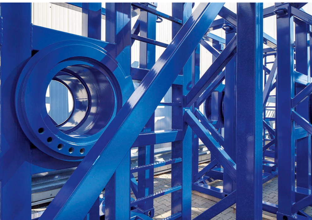
Transportgestell für Rotorblätter, beschichtet mit der ST-Serie.
